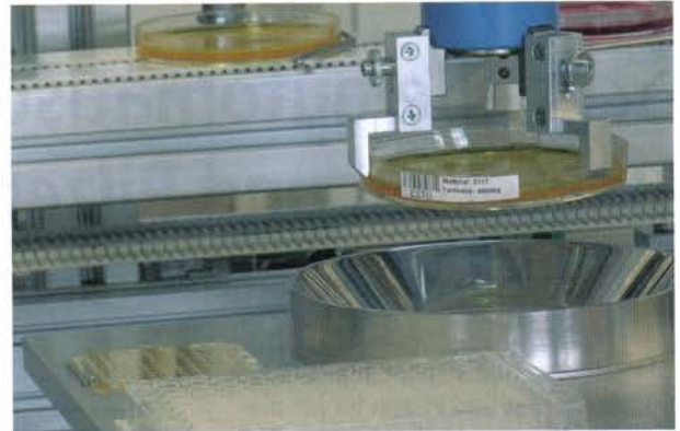
Abb. 3: Präzisions-Positioniertisch mit Rundumspiegel zur Barcoderkennung, Mikrotiterplatte zur Reinzuchtetablirung und MALDI-TOF Target zur Artidentifikation.
