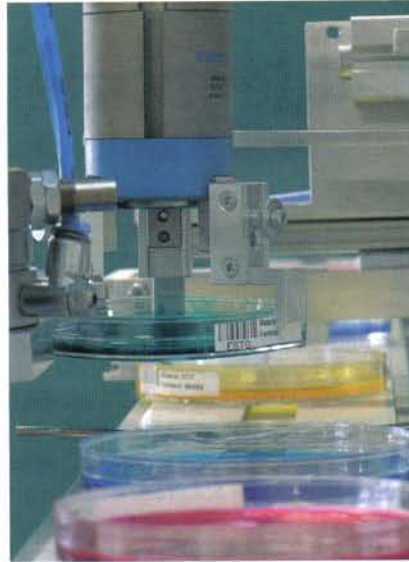
Abb. 2: Ein- und Ausschleusen der Petrischalen erfolgt über ein Förderband und ein Greifersystem. Ein Sauger nimmt zuvor die Deckel ab und verschließt die Schalen nach dem Ablauf.
